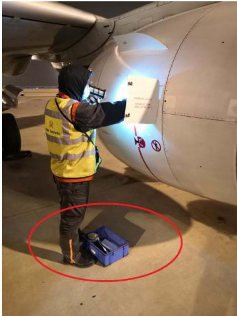
(14) 检查发动机叶片时逐片检查
